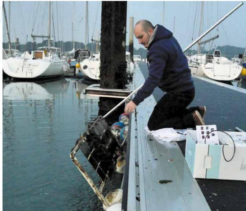
Tests en immersion de peintures antifouling, dans le cadre du laboratoire commun entre l'UBS et la société Nautix (LabCom SAFER).
